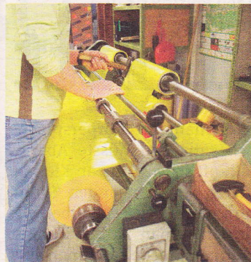
Zuschnitt: Die Folie, angeliefert als Rollenware, wird hier zugeschnitten
