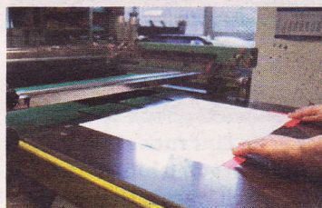
Kunststoff wird auch verschweißt und daraus entstehen etwa Flügelmappen
