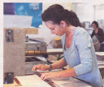
Kunststoff wird auch verschweißt und daraus entstehen etwa Flügelmappen
